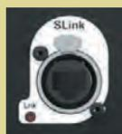
SLinkは、gigaACE、GX、DX、MEでの接続に対応したマルチプロトコルポートで、接続されたものに応じて自動的にモードを切り替えるインテリジェントなポートです。
