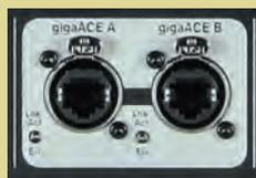
gigaACEは、ギガビット・イーサネットをベースに、96kHz、24bitで128×128チャンネルを提供するプラグアンドプレイシステムです。dLive SクラスのMixRackとサーフェス、およびオプションの「gigaACE」カードの使用時には、2つのリンクは常に稼働しており、どちらかのリンクにエラーが発生した場合やリンクが完全に失われた場合でも、音声や制御情報の損失はなく、シームレスなリダンダント化を実現します。
